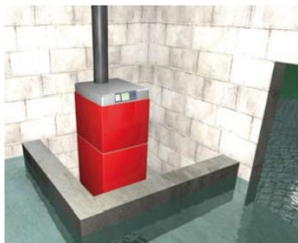
Protection d'un équipement de chauffage par une barrière permanente.
