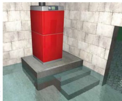
Protection d'un équipement de chauffage par surélévation.
